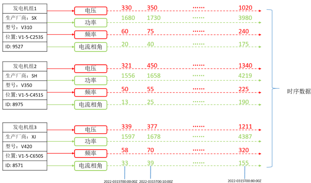
图 1-1 发电机组数据采样示意图
