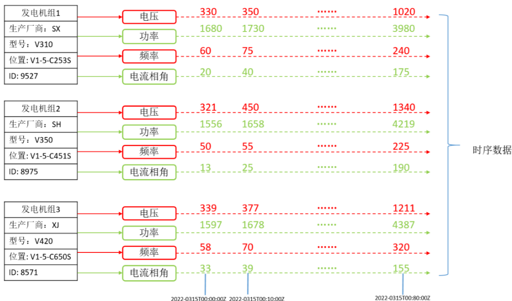
图 5-1 发电机组数据采样示意图
