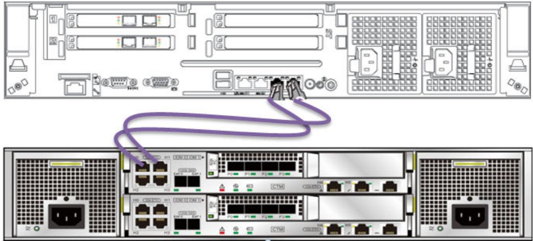
图 1-8 10GE 电端口通过光纤连接
